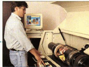
Hier sehen Sie den neu angeschafften Vierfarb-scanner der ebenfalls schon voll digital arbeitet, und bereits mit dem schnellsten Glasfaser-Netzwerk mit der Layout- und Composingabteilung per Bildschirm verbunden war. Es war das erste Glas-fasernetzwerk, das in einem Betrieb des Ennstales installiert wurde.
