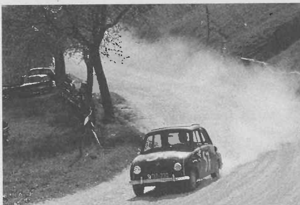
1959: Johann Schachner treibt sein Goggomobil mit Vollgas nach dem Heferer-Bühel der Hafner-Reith entgegen. Den Antrieb für das „Goggerl“ besorgte ein Zweizylinder-Zweitaktmotor mit 350 cm 3 . Die 12 PS reichten zum Klassensieg.
