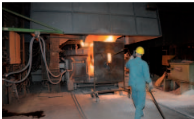
Auch beim sogenannten „Frischen“ wird nunmehr ein Großteil von Staub und Rauch aufgefangen.
