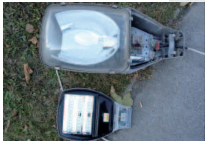
Dieses Bild zeigt die bisher verwendeten Leuchtmittel (im Beleuchtungskörper eingebaut) und darunter die neuen energiesparenden LED-Lampen.
