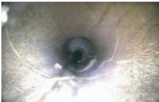
Schadhaftes Kanalrohr vor den Vorbereitungsarbeiten (Fräsarbeiten) für den Schlauchlinereinbau.
