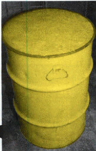
Ein Faß pro Werktag wird derzeit in Seibersdorf für die Endlagerung abgefüllt. Die Fässer (200 l Inhalt) wiegen etwa 400 kg.
